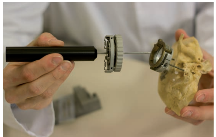
Las dos partes que componen la herramienta del micromanipulador.
