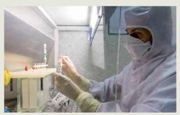
Laboratorio GMP. Una vez que el isótopo radiactivo sale del ciclotrón, llega a través de tubos subterráneos al Laboratorio GMP de Radiofarmacia, donde lo unen con una molécula específica apropiada para el tipo de tumor que se quiere detectar y/o tratar.
