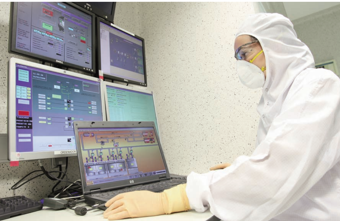
El control de la síntesis del radiofármaco se realiza de forma automatizada desde un ordenador de la sala de producción.
